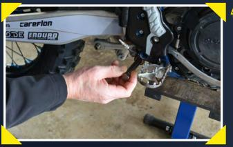
Nun können die Bolzen ohne Problem heraus genommen werden.Das Motorrad dazu auf einen stabilen Mittelständer stellen und mit der Hand die Schwinge leicht anheben. Somit wird der Druck auf die Umlenkung reduziert und beide Bolzen können einfach entnommen werden
