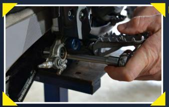
Ebenso muss der vordere Bolzen angezogen werden. Bei Husqvarna ist ein Anzugdrehmoment von 60 Nm vorgeschrieben.
