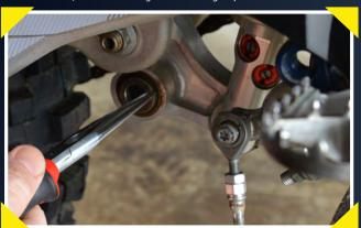
Die Arretierungshülsen mit einer Zange entfernen und das Lager auf Beschädigung und Schmutz überprüfen, gegebenenfalls austauschen
