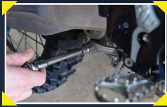
Zuerst muss die Muttern der originalen Umlenkung mit einem Ratschen- bzw. Ringschlüssel entfernt werden
