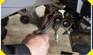
Jetzt kann die Original-Umlenkung entfernt werden
