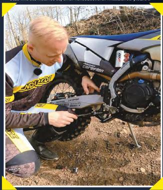
Für eine Änderung der Einstellung stellt man das Motorrad auf den Seitenständer und hält es mit der linken Schulter unter dem Auspuffendschalldämpfer fest. Nun kann man mit dem Ringschlüssel die Mutter vom Exzenter lösen und mit dem Inbusschlüssel den Exzenter auf die gewünschte Position drehen. Die Mutter nach dem Verstellen wieder festziehen.
