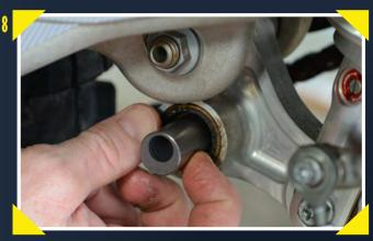
Jetzt wird die neue Exzenterhülse eingesetzt und anschließend die dazu gelieferten Arretierungshülsen draufgedrückt. Achtet hierbei genau auf die Übereinstimmung der Bohrungen, sonst kann der Bolzen nicht passend eingesetzt werden
