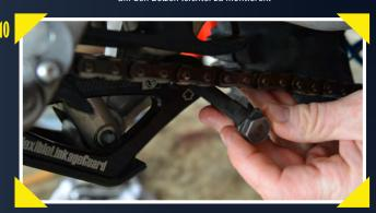
Auf der anderen Seite kann nun der Exzenterbolzen so eingesetzt werden, das die Std. (Standard)-Position zum Pfeil auf der Umlenkung steht.
