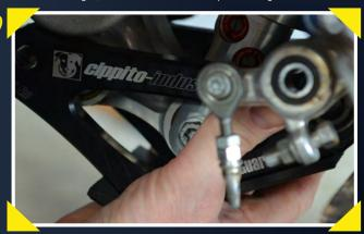
Nun kann die Umlenkung passend platziert und der vordere Bolzen eingesetzt werden. Auch hier wieder die Schwinge leicht anheben, um den Bolzen leichter zu montieren.
