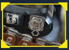
In der "std" Variante sind die Fahreigenschaften identisch zur Serienumlenkung. Nachdem wir den Exzenter auf "middle" eingestellt hatten, ließ sich das Motorrad ruhiger fahren. Das Hinterrad besitzt mehr Spurtreue und lässt weniger Kicks zu. Auch der Traktionsaufbau am Hinterrad ist spürbar besser. Beide Füße können wir leichter absetzen, besonders im Hardenduro-Bereich.
