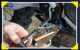
Der Fußbremshebel kann nun wieder montiert werden. Nicht vergessen, die Mutter mit einer Schraubensicherung einzukleben.
