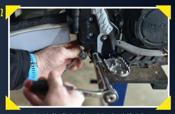
Um mehr Platz für den Umbau zu haben, kann bei Bedarf die Halterung vom Fußbremshebel gelöst und entfernt werden
