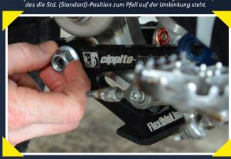
Nun wird die Mutter auf gesetzt und mit einem Drehmoment von 80 Nm fest angezogen werden.
