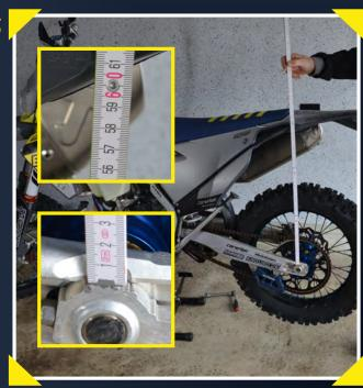
Beim Nachmessen der einzelnen Stufen, ergeben sich nun folgende Werte. "std" Variante = 60 cm, "middle" Variante = 61,2 cm, "low" Variante =63,0 cm ( Ohne eine Beeinträchtigung über dem Durchhang) Die Messung wurde bei komplett entlastetem Hinterrad vorgenommen. Dazu wird das Motorrad auf einen handelsüblichen Mittelständer platziert.
